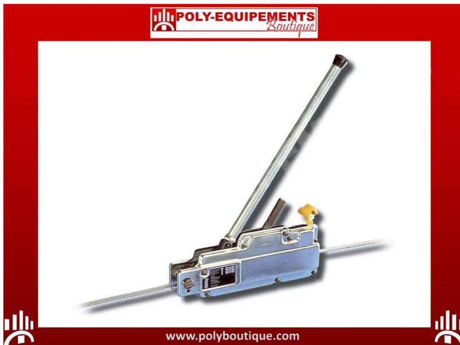
*Les appareils Tirfor® sont des treuils manuels portables à câble passant. Ils peuvent lever, tirer et positionner des charges sur une grande longueur tout en gardant leur couple maximum. Ils peuvent être utilisés dans de multiples configurations. Les manœuvres se font à l'aide d'un levier.*
